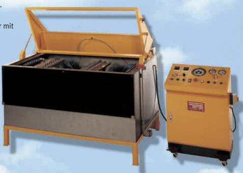
MAXIMATOR-Druckprüfstand für Schläuche (Luft unter Wasser)
