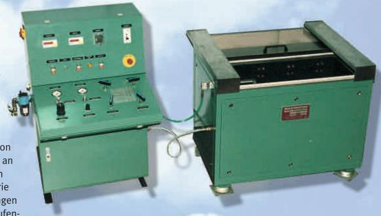
Der Prüfstand kann für Druck-, Berstdruck- sowie Impulsdruckprüfungen nach TRG 760 Anlage 1, Ausgabe 1.85, 5.4 eingesetzt werden. Damit ist die Anlage auch für andere Zwecke universell verwendbar, sofern keine serienbegleitende Prüfung erfolgt.
